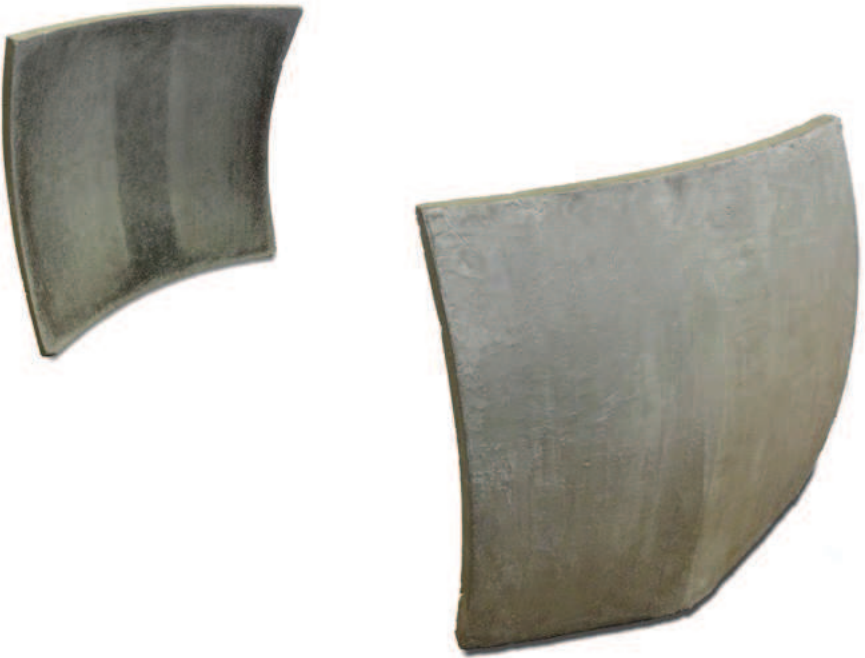
Fig.: Maquette d'une alcôve de focalisation du son par des paraboles
